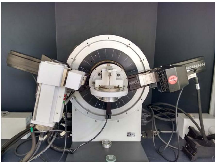
Figura 49 Difractómetro Bruker Advance
