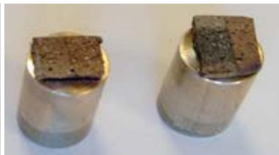
Figura 46 Muestras con recubrimiento de oro
